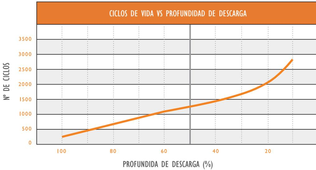
El ciclo de vida puede variar según la aplicación y se ve afectado por la frecuencia de los ciclos, la temperatura de funcionamiento, la profundidad de descarga (% DOD), el cumplimiento de los parámetros de carga recomendados por el fabricante y el mantenimiento adecuado.
